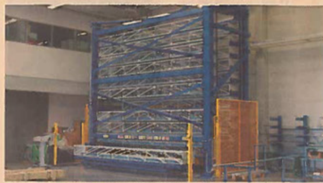
DIVISIONE AUTOMHA PER LO STOCCAGGIO VERTICALE AUTOMATIZZATO. HEAVYTOWER, MAGAZZINO VERTICALE CORPI LUNGI E LAMIERE
