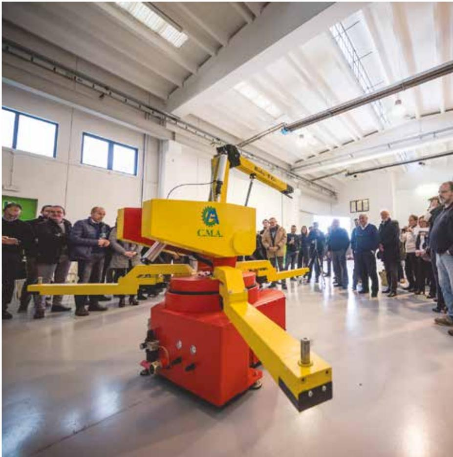
5 – Un'altra immagine dell'area dello stabilimento che sarà utilizzata come "laboratorio-showroom" per le dimostrazioni delle macchine. In primo piano, uno degli storici robot con carosello per la verniciatura delle sedie.
